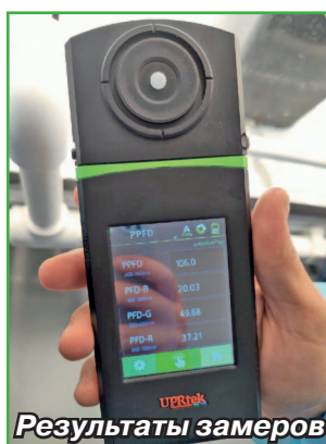
Селянский А. И. проводит замеры спектрофотометром уровня освещённости
